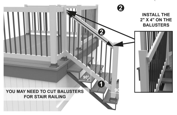
ADJUST THE RAILING SO THAT THE BALUSTERS ARE STRAIGHT BY MOVING THE RAILING FROM LEFT TO RIGHT.
