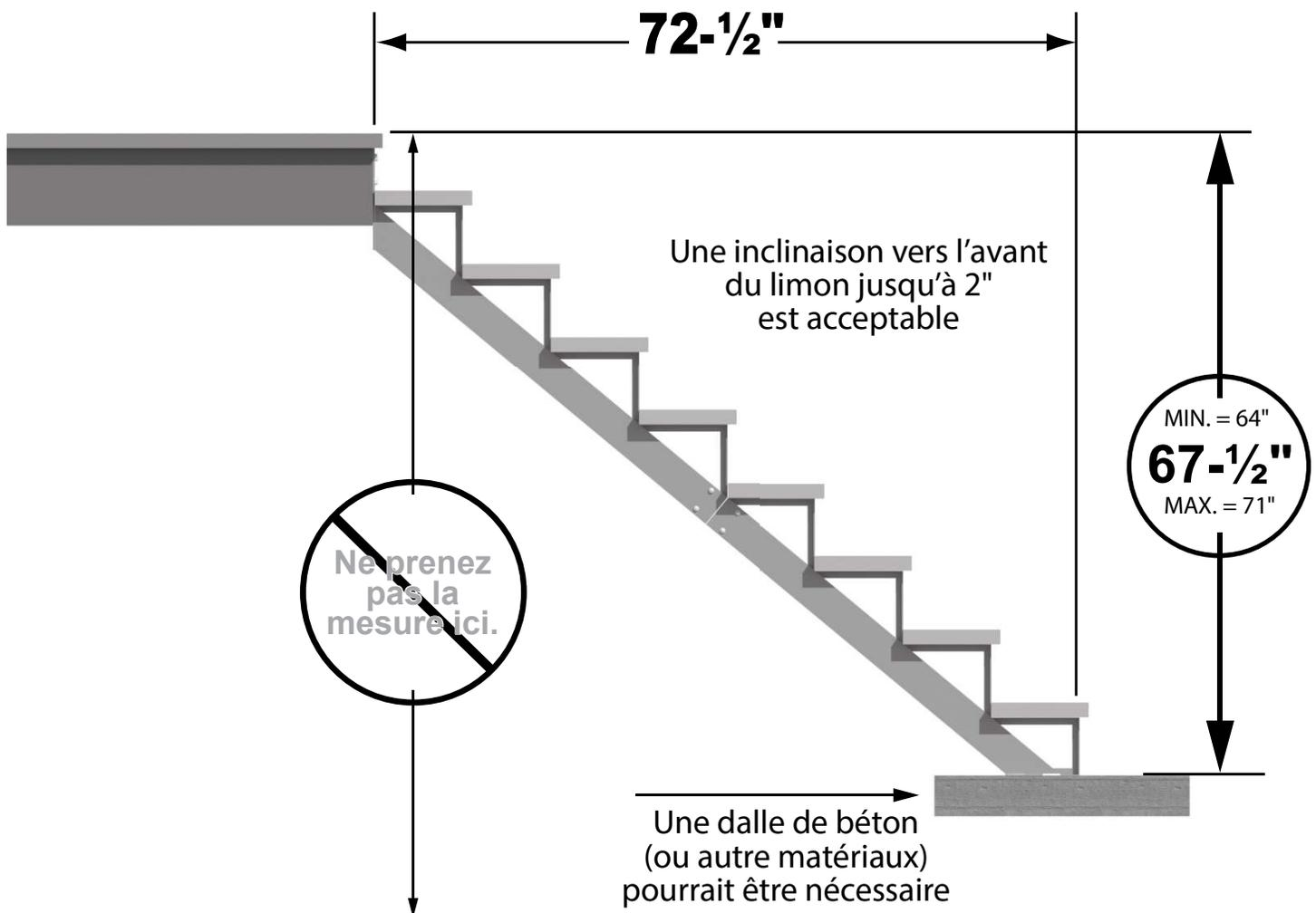
Avant d'installer ce produit, assurez-vous d'être conforme aux normes de construction de votre région. Vérifiez auprès de votre municipalité pour ne pas atteindre des installations souterraines ou publiques. Ce produit peut potentiellement être dangereux s'il est utilisé de façon non conforme.
