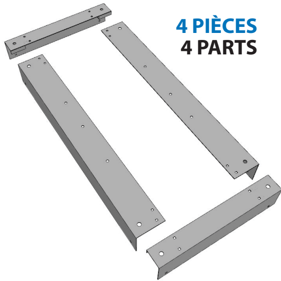
POSITION DES TROUS (Idem pour l'autre côté mais inversé)
